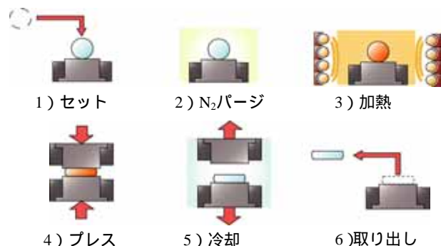
図2 ガラスの成形プロセス
